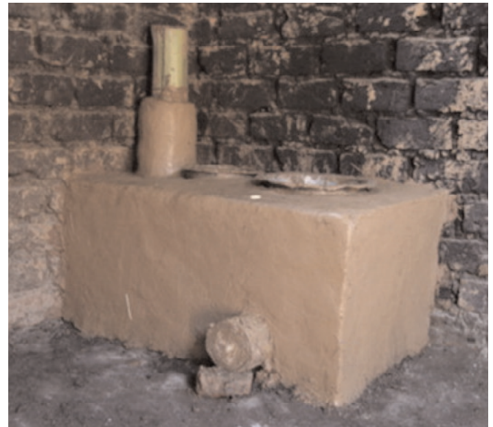
Ein einfacher Herd, mit einer besonders effizienten Brennkammer
